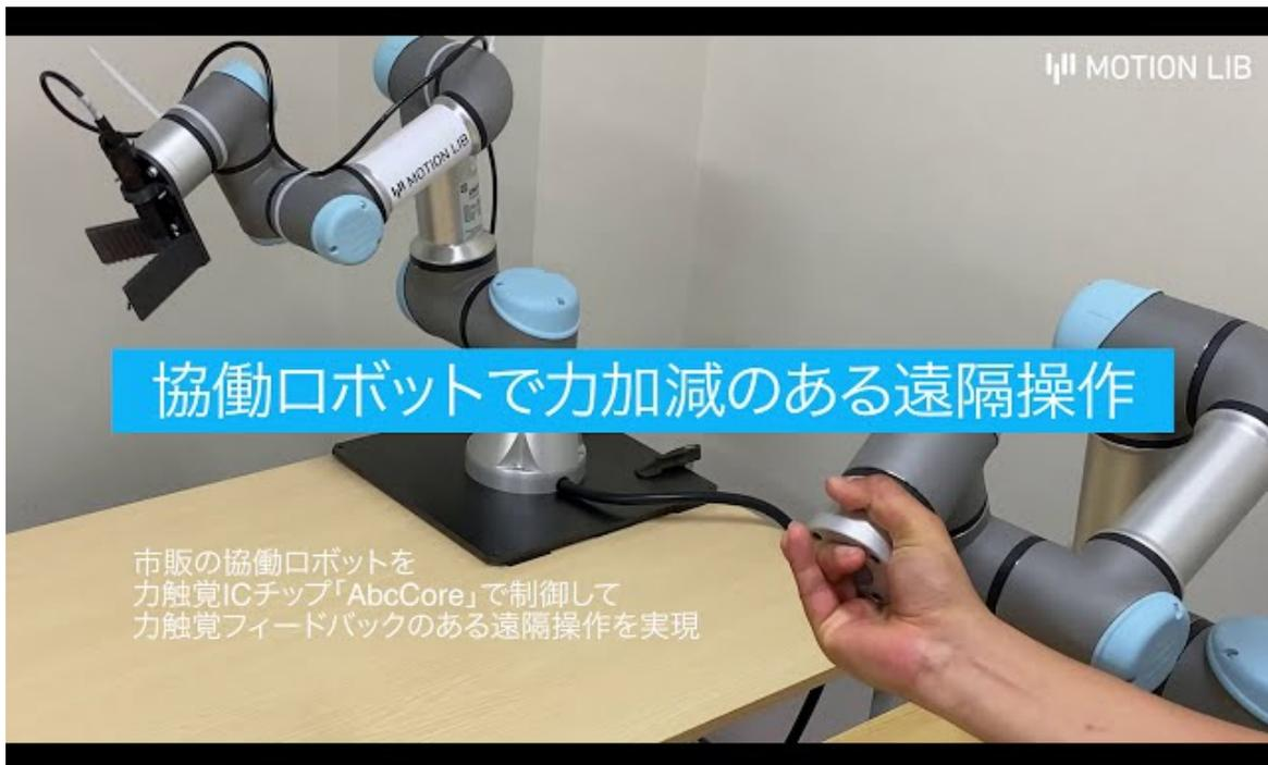
2台のUR3eで感触が伝わる（感触のフィードバックがある）遠隔操作を実現することができます。UR3e本体への改造を加えない外付けのシステムであるため、お手持ちのUR3eにそのまま適用することが可能です。
